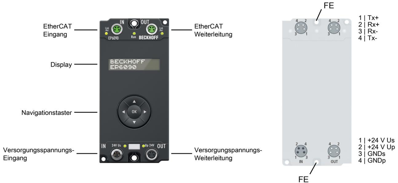
Die Displaybox EP6090-0000 verfügt über ein beleuchtetes, reflexarmes LC-Display mit zwei Zeilen à 16 Zeichen. Sie kann z. B. für die Anzeige von Statusmeldungen oder Diagnoseinformationen verwendet werden. Ein nicht zurücksetzbarer Betriebsstundenzähler ist integriert und kann sowohl angezeigt als auch über die Steuerung ausgelesen werden.
