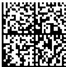
Abb. 9: Beispiel-DMC 1P 072222 SBTN k4p562d7 1K EL1809 Q 1 51S 678294
