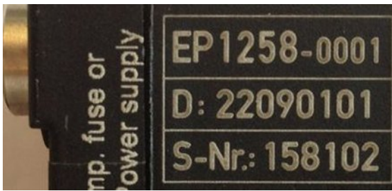
Abb. 28: EP1258-0001 IP67 EtherCAT Box mit Chargennummer/ DateCode 22090101 und eindeutiger Seriennummer 158102
