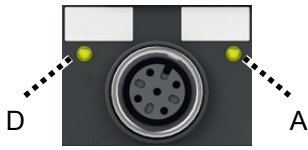
Abb. 11: Status-LEDs für Signal-Eingänge und -Ausgänge
