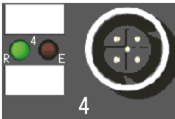
Abb. 6: Status- und Diagnose-LED am M12-Steckverbinder
