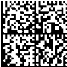
Fig. 11: Example DMC 1P 072222 SBTN k4p562d7 1KEL 1809 Q1 51S 678294
