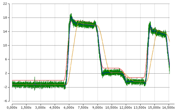
Abb. 7: Winkelmessung, Prozessdaten als Beschleunigungswerte, Berechnung im PC
