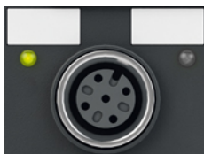
Abb. 28: Status-LED an einer M12-Buchse von EP1008-0022
