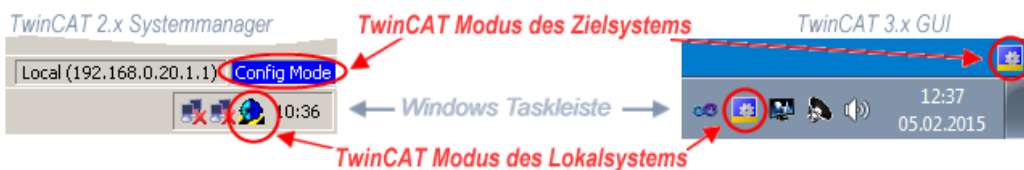
Abb. 50: Unterscheidung Lokalsystem/ Zielsystem (links: TwinCAT 2; rechts: TwinCAT 3)
