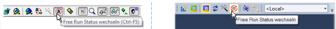
Abb. 62: TwinCAT kann auch durch einen Button in diesen Zustand versetzt werden (links: TwinCAT 2; rechts TwinCAT 3)
