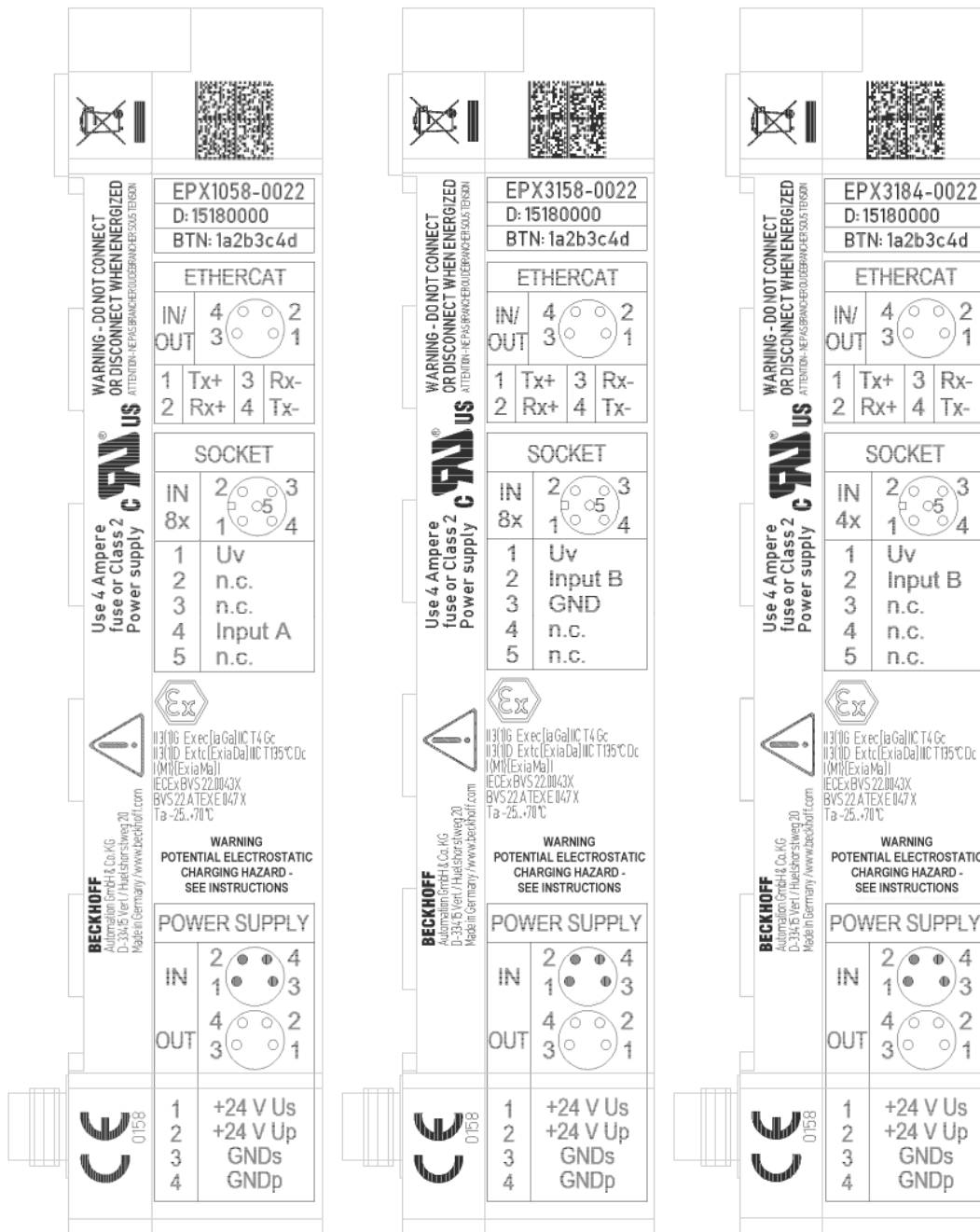
Abb. 1: Seitliches Typenschild von EPX1058-0022, EPX3158-0022 und EPX3184-0022
