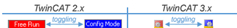
Abb. 61: Anzeige des Wechsels zwischen „Free Run“ und „Config Mode“ unten rechts in der Statusleiste
