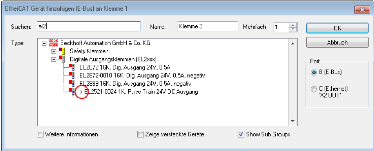
Abb. 36: Kennzeichnung einer online erfassten ESI am Beispiel EL2521
