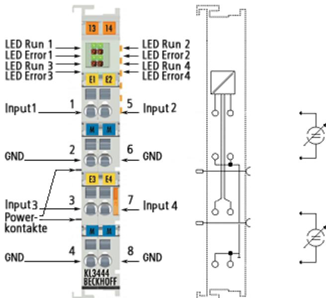
Abb. 18: KL3444 - Anschlussbelegung
