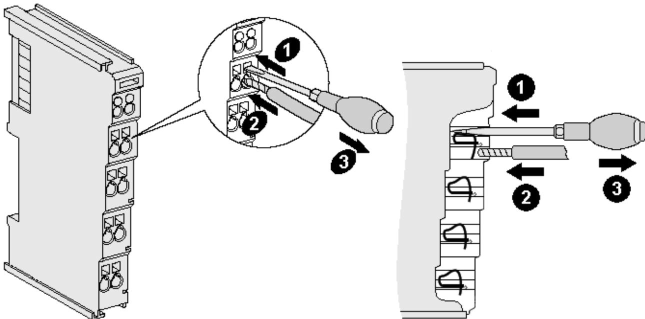
Abb. 17: Anschluss einer Leitung an eine Klemmstelle
