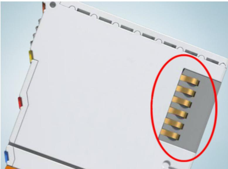
Abb. 10: Federkontakte der Beckhoff I/O-Komponenten
