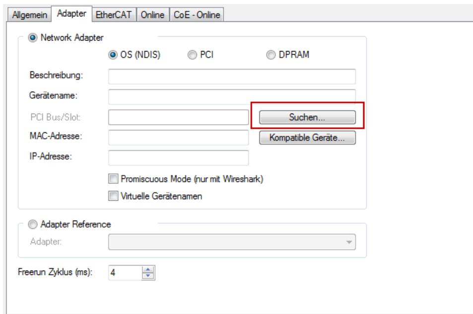
Abb. 28: Suche der bestehenden HW-Konfiguration zur bestehenden EtherCAT-Konfiguration
