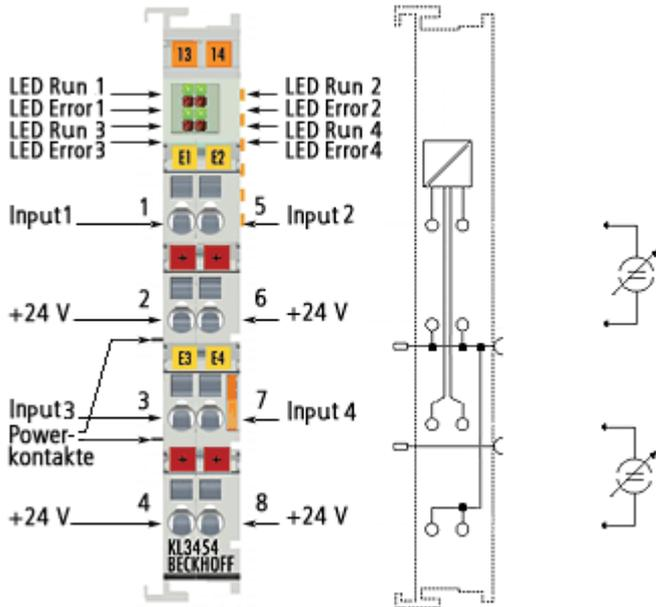
Abb. 19: KL3454 - Anschlussbelegung
