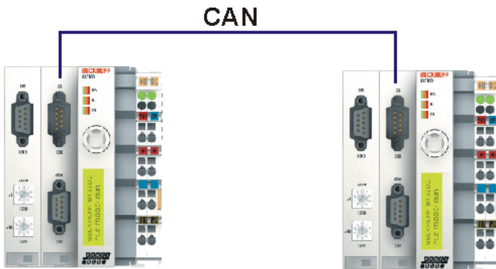
Abb. 69: Kommunikation von BX-Controller zu BX-Controller (über SSB)
