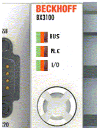
Abb. 164: Diagnose LEDs für den Feldbus, die SPS und den K-Bus
