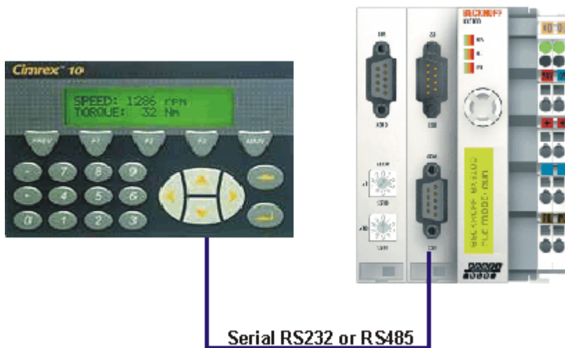
Abb. 125: Cimrex-Panel am COM-Port des BX-Controllers
