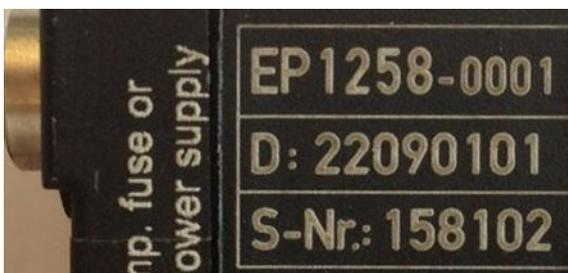
Abb. 60: EP1258-0001 IP67 EtherCAT Box mit Chargennummer/ DateCode 22090101 und eindeutiger Seriennummer 158102
