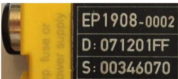
Abb. 61: EP1908-0002 IP67 EtherCAT Safety Box mit Chargennummer/ DateCode 071201FF und eindeutiger Seriennummer 00346070
