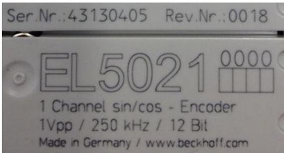
Abb. 56: EL5021 EL-Klemme, Standard IP20-IO-Gerät mit Seriennummer/ Chargennummer und Revisionskennzeichnung (seit 2014/01)
