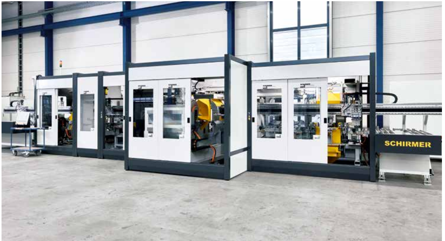
这台 14 米长的 Schirmer 机器用于 PVC 窗型材的全自动加工, 是第一款用 MX-System 系统取代所有先前所需的控制柜的机器
