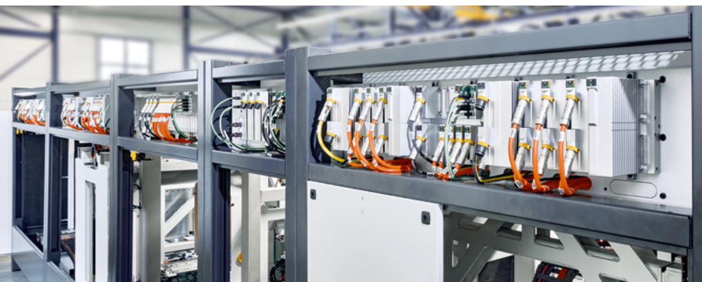
システム背面は自動化エンジニアには特に興味深いものです。各機械モジュールごとにMX-Systemベースプレートがあり、その上に様々な機能モジュールがネジで固定され、取り付けられています。
