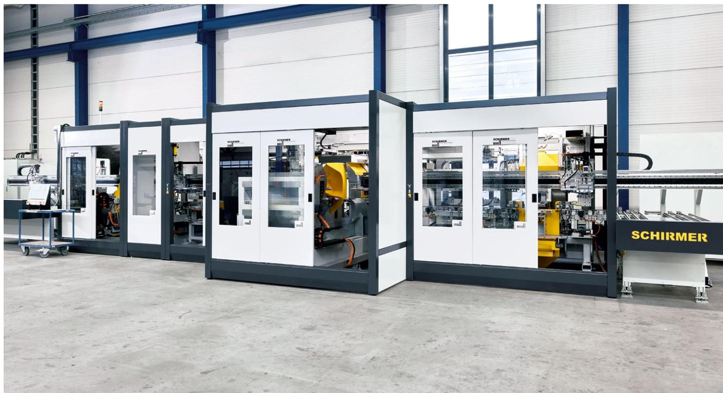
Bei dieser 14 m langen Schirmer-Maschine für die vollautomatische Bearbeitung von PVC-Fensterprofilen wurden mit dem MX-System erstmals alle bislang erforderlichen Schaltschranke ersetzt.
