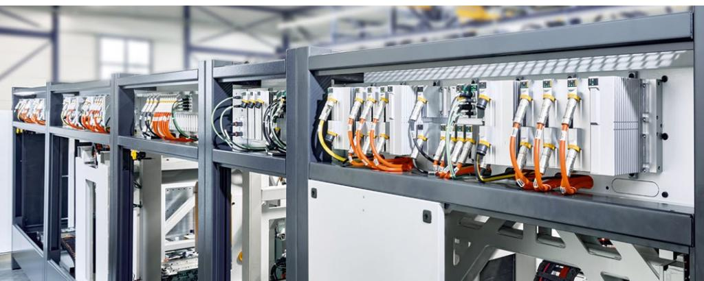
Für einen Automatisierer ist die Anlagenrückseite interessant: Jedes Maschinenmodul verfügt über eine eigene MX-System-Baseplate, auf der die verschiedenen Funktionsmodule aufgesteckt und verschraubt sind.
