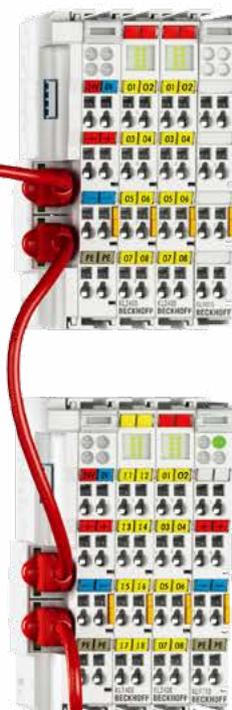
如果控制器发生故障，使用手动操作模块可以实现数字量和模拟量信号的切换、控制和监控以及数据和数值的设置和读取。过程数据连接通过带 K-bus 扩展功能（最多 31 个模块）的 K-bus 接口实现。信号连接通过 KL9309 实现
