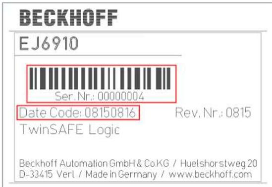
Abb. 4: Eindeutige Seriennummer eines TwinSAFE-EJ-Moduls
