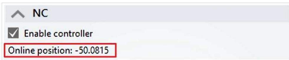
Anhand des Online-Position-Wertes sehen Sie wie der Motor verfährt. Der Motor befindet sich innerhalb der erlaubten Geschwindigkeit.
