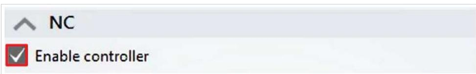
9. Im Feld „NC“ den Kasten bei „Enable controller“ anklicken
