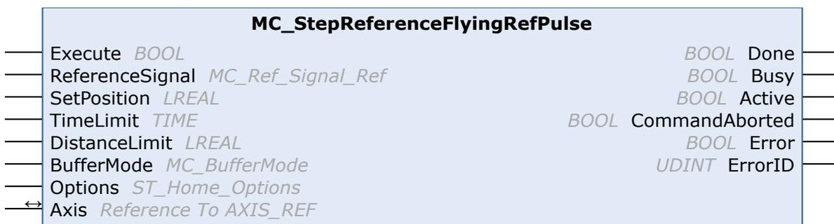
Der Funktionsbaustein MC\_StepReferenceFlyingRefPulse führt eine Referenzierung während einer laufenden Bewegung auf den Nullimpuls eines Gebers durch.
