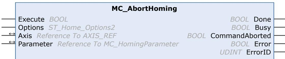
Der Funktionsbaustein MC\_AbortHoming bricht eine Homing-Sequenz ab und sorgt dafür, dass modifizierte Parameter wieder auf ihren ursprünglichen Wert zurückgesetzt werden. Die Achse verlässt den Homing-State.
