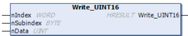
Schreibt einen UINT16 Parameter des IO-Link-Geräts und schaltet die Bytes in High Endian um.
