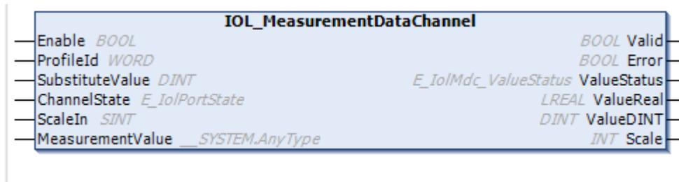
Der Messdatenkanal definiert die Prozessdatenstruktur, Funktionen und Darstellung von Messsensoren. Der Funktionsblock wird definiert, um abgeleitete Statussignale bereitzustellen und eine standardisierte Schnittstelle für Anwenderprogramme zu ermöglichen.
