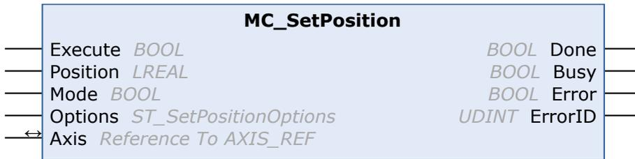
Der Funktionsbaustein MC\_SetPosition setzt die aktuelle Achsposition auf einen parametrierbaren Wert.
