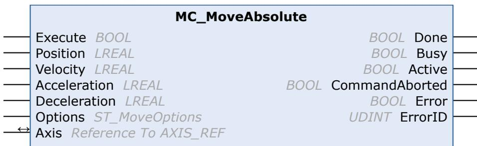
Der Funktionsbaustein MC\_MoveAbsolute startet eine Positionierung auf eine absolute Zielposition und überwacht die Achsbewegung über den gesamten Fahrweg. Der Ausgang „Done“ wird gesetzt, wenn die Zielposition angefahren wurde. Anderenfalls wird der Ausgang „CommandAborted“ oder im Fehlerfall der Ausgang „Error“ gesetzt.
