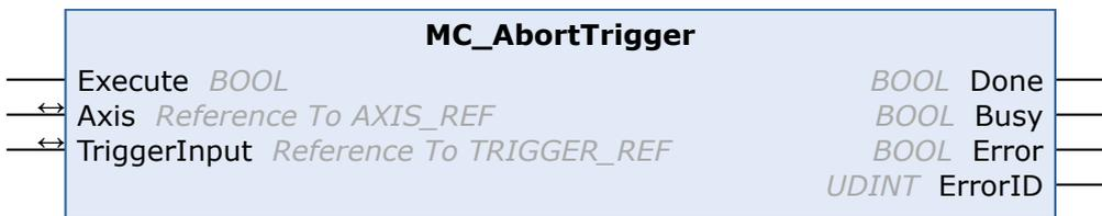
Der Funktionsbaustein MC\_AbortTrigger bricht einen durch MC\_TouchProbe gestarteten Messtasterzyklus ab. MC\_TouchProbe startet einen Messtasterzyklus, indem ein Positionslatch in der Antriebs-Hardware aktiviert wird. Um den Vorgang zu beenden, bevor das Trigger-Signal das Positionslatch aktiviert hat, kann der Baustein MC\_AbortTrigger verwendet werden. Wurde der Messtasterzyklus erfolgreich beendet, ist es nicht notwendig, diesen Baustein aufzurufen.
