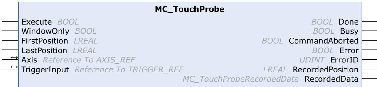
Der Funktionsbaustein MC\_TouchProbe erfasst eine Achsposition zum Zeitpunkt eines digitalen Signals (Messtasterfunktion). Die Position wird über ein externes Hardware-Latch erfasst und ist damit hochgenau und von der Zykluszeit unabhängig. Der Baustein steuert diesen Mechanismus und ermittelt die extern erfasste Position.
