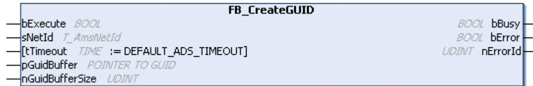
该功能块可生成一个新的 GUID。如果在输入端将一个 GUID 类型的数组指定为缓冲区，则通过一次调用即可获取不同的新 GUID 的列表。
