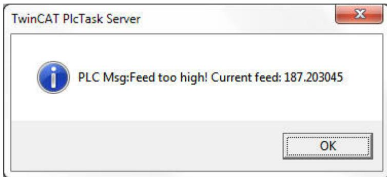
此处将 LREAL 值 187.203045 插入消息。插入点由格式字符串中的 %f 字符标记。输出时，该数值的小数部分会在第六位后被截断。
