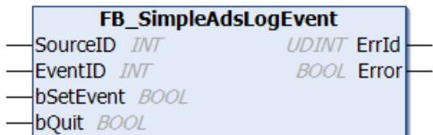
该功能块允许向 TwinCAT EventLogger 发送和确认消息。与 ADSLOGEVENT 程序块不同，通过 FB\_SimpleAdsLogEvent 程序块不能从 PLC 对事件进行参数设置；但可以通过简单的方式对事件进行设置、重置和确认。
