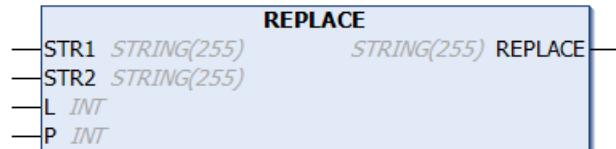
函数 REPLACE 用于将长字符串的某子字符串替换为第三个字符串。
