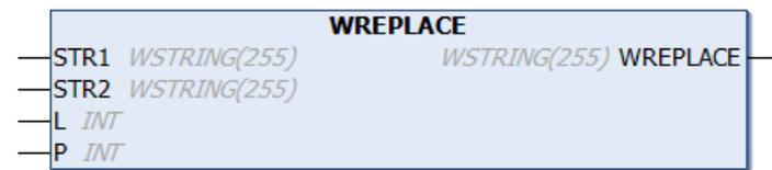
Die Funktion WREPLACE ersetzt einen Teilstring eines WSTRINGs durch einen anderen WSTRING.
