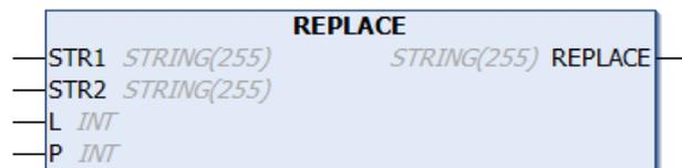
Die Funktion REPLACE ersetzt einen Teilstring eines Strings durch einen anderen String.
