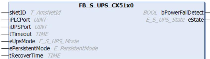
Der Funktionsbaustein FB\_S\_UPS\_CX51x0 kann auf den CX51x0 mit Sekunden-USV verwendet werden, um die Sekunden-USV aus der SPS anzusteuern. So können bei Spannungsausfall je nach ausgewähltem Modus die persistenten Daten gespeichert werden und/oder ein QuickShutdown ausgeführt werden. Die voreingestellten Werte der INPUTs des FB\_S\_UPS\_CX51x0 sollten beibehalten werden.
