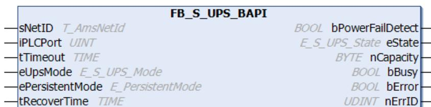
Der Funktionsbaustein FB\_S\_UPS\_BAPI kann auf Geräten mit Sekunden-USV und mit BIOS-API ab Version v1.15 verwendet werden, um die Sekunden-USV aus der SPS anzusteuern.
