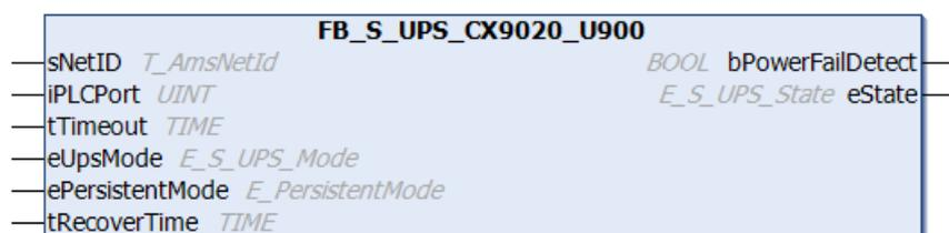
Der Funktionsbaustein FB\_S\_UPS\_CX9020\_U900 kann auf dem CX9020-U900 mit Sekunden-USV verwendet werden, um die Sekunden-USV aus der SPS anzusteuern. So können bei Spannungsausfall je nach ausgewähltem Modus noch die persistenten Daten gespeichert und/oder ein QuickShutdown ausgeführt werden. Die voreingestellten Werte der INPUTs des FB\_S\_UPS\_CX9020\_U900 sollten beibehalten werden.
