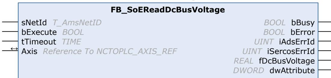
通过 FB\_SoEReadDcBusVoltage 功能块来读取驱动器（S-0-0380）的 DC 总线电压。
