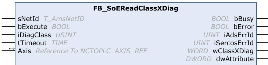
通过功能块 FB\_SoEReadClassXDiag, 可以 WORD 形式读出当前的 Class 1 诊断信息 (S-0-0011) ... 可以 WORD 的形式读出 Class 3 诊断信息 (S-0-0013)。可使用转换函数 F\_ConvWordToSTAX5000C1D 以 ST\_AX5000\_C1D 结构形式对 Class 1 诊断进行评估 (参见 TwinCAT 3 PLC Lib Tc2\_Drive 文档)。
