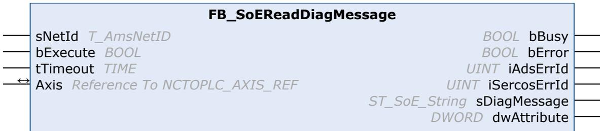
通过 FB\_SoEReadDiagMessage 功能块，可以 Sercos 字符串（S-0-0095）的形式读出诊断消息。
