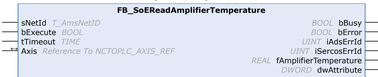
通过 FB\_SoEReadAmplifierTemperature 功能块来读取驱动器 (S-0-0384) 的温度。
