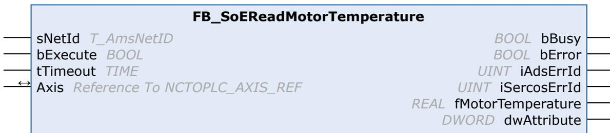
通过功能块 `FB_SoEReadMotorTemperature` 来读取电机 (S-0-0383) 的温度。如果电机不带温度传感器，则该值为 0.0，即 0.0°C。
