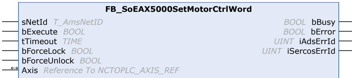
通过功能块 FB\_SoEAX5000SetMotorCtrlWord，可以在电机控制字（P-0-0096）中设置 ForceLock 位（0 位）或 ForceUnlock 位，以激活或释放制动器。通常通过驱动器的 Enable 功能来自动控制制动器。
