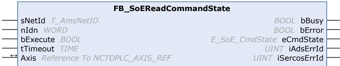
通过 FB\_SoEReadCommandState 功能块来检查命令的执行情况。
