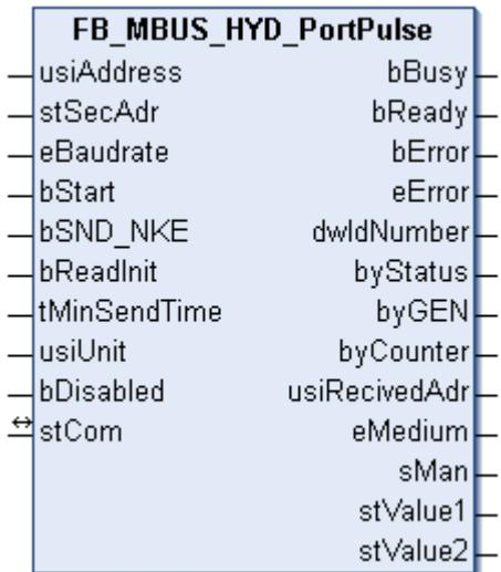
Der Funktionsbaustein FB\_MBUS\_HYD\_PortPulse dient zum Auslesen von Energiezählern mit Impulsausgang der Firma Hydrometer:
