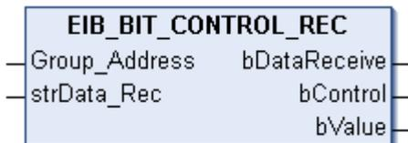
Dieser Funktionsbaustein empfängt auf der eingestellten Gruppenadresse 2 Bit EIB-Daten und konvertiert diese in zwei IEC61131-3 BOOL-Variablen.
