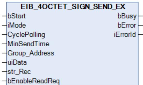
Dieser Funktionsbaustein sendet einen 4 Byte Sign EIB-Wert zur eingestellten Gruppenadresse. Als Eingabewert steht Ihnen ein IEC61131-3 DINT-Wert zur Verfügung. In Abhängigkeit des Modus (*iMode*) können die Daten Manuell, Polling oder OnChange gesendet werden.
