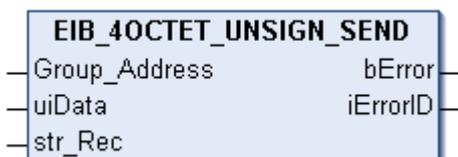
Dieser Funktionsbaustein sendet einen 4 Byte Unsign EIB-Wert zur eingestellten Gruppenadresse. Als Eingabewert steht Ihnen ein IEC61131-3 UDINT-Wert zur Verfügung. Die Daten werden nur bei Änderung übertragen. Ändert sich der Wert innerhalb einer Sekunde erneut, werden erst nach Ablauf von einer
