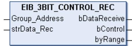
Dieser Funktionsbaustein empfängt auf der eingestellten Gruppenadresse 4 Bit EIB-Daten und konvertiert diese in eine IEC61131-3 BOOL-Variable und in eine BYTE-Variable.
