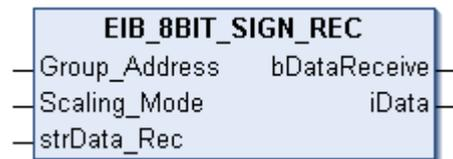
Dieser Funktionsbaustein empfängt auf der eingestellten Gruppenadresse 8 Bit EIB-Daten und konvertiert diese in eine IEC61131-3 INT-Variable. Zusätzlich kann der Wert automatisch umgerechnet werden.
