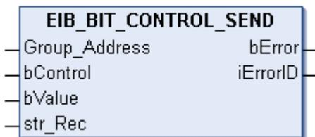
Dieser Funktionsbaustein sendet einen 2 Bit EIB-Wert zur eingestellten Gruppenadresse. Als Eingabewert stehen Ihnen zwei IEC61131-3 BOOL-Variablen zur Verfügung. Die Daten werden nur bei Änderung einer der beiden Datentypen übertragen. Ändert sich der Wert innerhalb von 200ms erneut, werden erst nach
