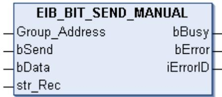
Dieser Funktionsbaustein sendet einen 1 Bit EIB-Wert zur eingestellte Gruppenadresse. Als Eingabewert steht Ihnen eine IEC61131-3 BOOL-Variable zur Verfügung. Die Daten werden bei einer positiven Flanke von *bSend* gesendet. Solange der Baustein aktive ist, ist das *bBusy* gesetzt. *bBusy* wird auf FALSE gesetzt sobald der EIB Befehl gesendet wurde oder ein Fehler vorliegt. Ein Fehler wird mit setzen der *bError* Variable angezeigt. Der Fehlercode ist dann im *iErrorID* angegeben.
