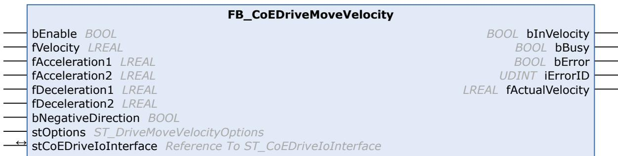
Der Funktionsbaustein FB\_CoEDriveMoveVelocity erzeugt ein einfaches Dreiphasen-Geschwindigkeitsprofil (ohne Ruckbegrenzung), mit dem ein CoE-Antrieb direkt versorgt werden kann. Unterhalb und oberhalb einer parametrierbaren Geschwindigkeitsschwelle können unterschiedliche Beschleunigungen bzw. Verzögerungen verwendet werden. Die Zielgeschwindigkeit kann im Betrieb geändert werden.
