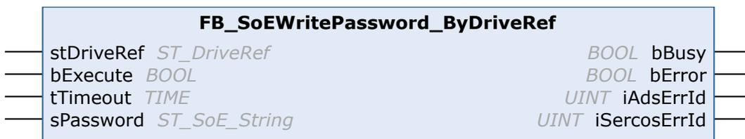
Mit dem Funktionsbaustein FB\_SoEWritePassword\_ByDriveRef kann das Antriebspasswort (S-0-0267) gesetzt werden.
