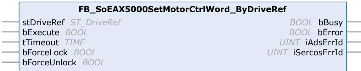
Mit dem Funktionsbaustein FB\_SoEAX5000SetMotorCtrlWord\_ByDriveRef kann das ForceLock-Bit (Bit 0) bzw. das ForceUnlock-Bit im Motor Control Word (P-0-0096) gesetzt werden, um die Bremse zu aktivieren oder zu lösen. Im Normalfall wird die Bremse automatisch über das Enable des Antriebs gesteuert.
