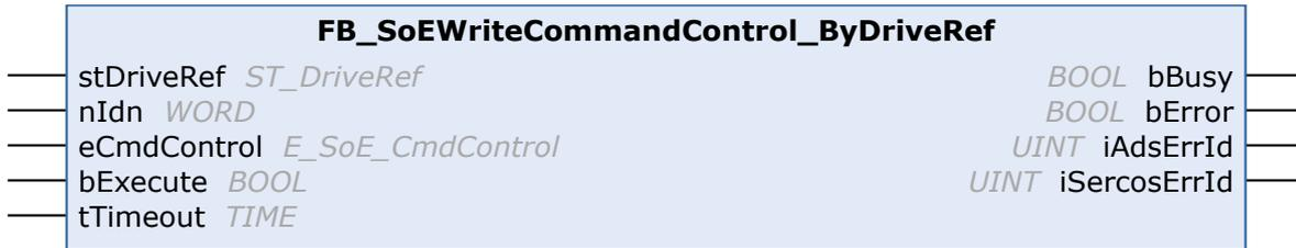
Mit dem Funktionsbaustein FB\_SoEWriteCommandControl\_ByDriveRef kann ein Kommando vorbereitet, gestartet oder abgebrochen werden.
