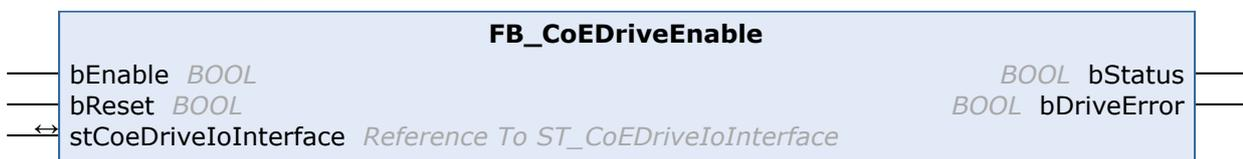
Der Funktionsbaustein FB\_CoEDriveEnable gibt einen CoE-Antrieb frei, um ihn anschließend mit dem Funktionsbaustein [FB\\_CoEDriveMoveVelocity](#) [[▶ 42](#)] mit Sollwerten versorgen zu können.
