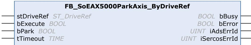
Mit dem Funktionsbaustein FB\_SoEAX5000ParkAxis\_ByDriveRef wird die Parkfunktionalität eines AX5000 aktiviert. Ein geparkter Kanal eines AX5000 ist temporär deaktiviert.
