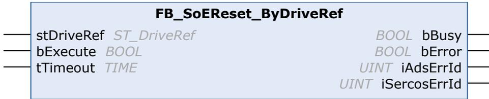
Mit dem Funktionsbaustein FB\_SoEReset\_ByDriveRef kann ein Reset des Antriebs (S-0-0099) ausgeführt werden. Bei mehrkanaligen Geräten müssen ggf. beide Kanäle einen Reset ausführen. Die Timeout-Zeit muss 10 s betragen, da der Reset je nach Fehler bis zu 10 s dauern kann. Ein NC-Reset wird nicht ausgeführt.
