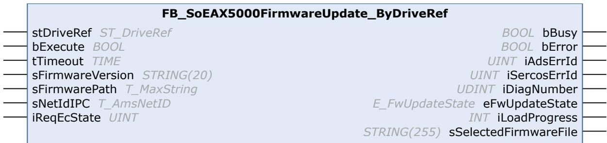
Mit dem Funktionsbaustein FB\_SoEAX5000FirmwareUpdate\_ByDriveRef kann die Firmware des AX5000 überprüft und automatisch auf eine bestimmte Version (Revision und Build) oder auf das aktuellste Build der konfigurierten Revision geändert werden.
