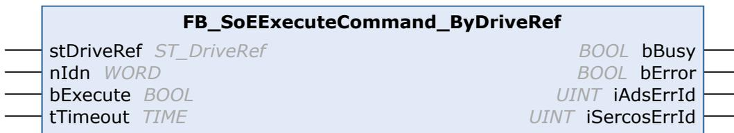
Mit dem Funktionsbaustein FB\_SoEExecuteCommand\_ByDriveRef kann ein Kommando ausgeführt werden.
