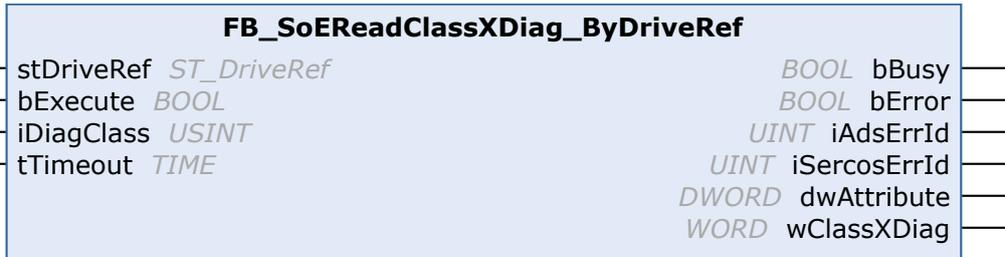
Mit dem Funktionsbaustein FB\_SoEReadClassXDiag\_ByDriveRef kann die aktuelle Class-1-Diagnose (S-0-0011) ... Class-3-Diagnose (S-0-0013) als WORD ausgelesen werden. Für die Auswertung der Class-1-Diagnose als Struktur [ST\\_AX5000\\_C1D \[▶ 49\]](#) gibt es die Konvertierungsfunktion [F\\_ConvWordToSTAX5000C1D \[▶ 31\]](#).
