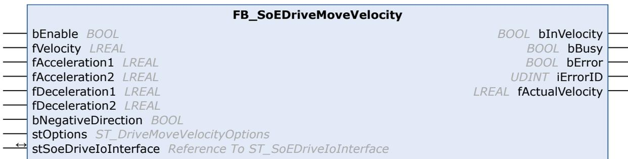
Der Funktionsbaustein FB\_SoEDriveMoveVelocity erzeugt ein einfaches Dreiphasen-Geschwindigkeitsprofil (ohne Ruckbegrenzung), mit dem ein SoE-Antrieb direkt versorgt werden kann. Unterhalb und oberhalb einer parametrierbaren Geschwindigkeitsschwelle können unterschiedliche Beschleunigungen bzw. Verzögerungen verwendet werden. Die Zielgeschwindigkeit kann im Betrieb geändert werden.
