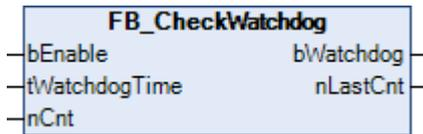
Überwachen eines Watchdog-Signals, das mit dem Baustein [FB\\_WriteWatchdog \[▶ 22\]](#) übertragen wird.
