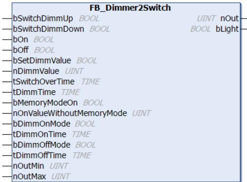
Der Baustein entspricht im Funktionsumfang dem Baustein `FB_Dimmer1Switch()` [► 38]. Der Unterschied besteht darin, dass bei dem Baustein `FB_Dimmer2Switch` zwei Schalter angeschlossen werden. Hierdurch kann der Bediener gezielt Auf- oder Abdimmen.
