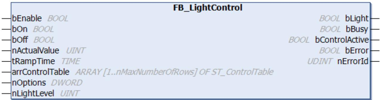
Baustein zur tageslichtabhängigen Lichtsteuerung mit bis zu 30 Stützpunkten.
