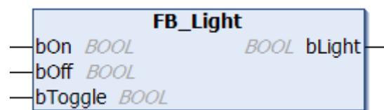
Durch eine positive Flanke an dem Eingang *bOn* wird der Ausgang *bLight* gesetzt. Zurückgesetzt wird der Ausgang durch eine positive Flanke an dem Eingang *bOff*. Wird an *bToggle* eine positive Flanke angelegt, so wird der Ausgang negiert; also von An nach Aus, bzw. von Aus nach An umgeschaltet.
