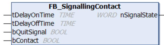
Über die beiden Eingänge *tDelayOnTime* und *tDelayOffTime* kann eine Abfall- und Anzugsverzögerung eingestellt werden. Soll eine Meldung quittiert werden bevor diese beendet werden kann, so wird dieses über den Eingang *bQuitSignal* realisiert. Der Meldekontakt wird über den Eingang *bContact* an den Baustein übergeben.
