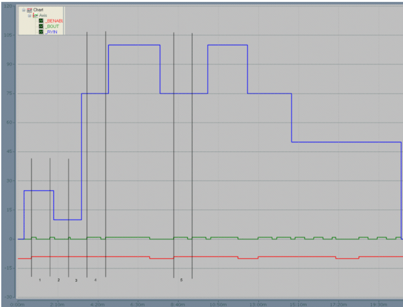
Bild: Scope2 Aufzeichnung, die die Funktionsweise des Bausteines zusätzlich erklären soll. Mit der Freigabe des Bausteines ( bEnable = TRUE) wird der Ausgang ( bOut = TRUE) gesetzt. Siehe auch Abschnitt 1 und 5. Eine Veränderung der Eingangsgröße während einer laufenden Periode wird erst in der nächsten Periode berücksichtigt. Siehe auch Abschnitt 2, 3 und 4.
