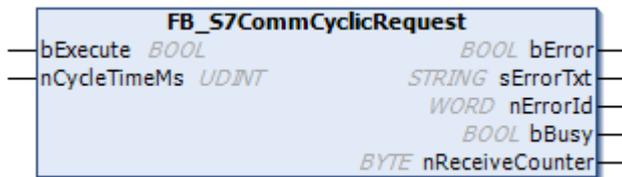
Mit dem Funktionsbaustein FB\_S7CommCyclicRequest kann eine zyklische Abarbeitung (read/write) von Datenpunkten einer S7 Kommunikationsverbindung konfiguriert werden. Über den Ausgang bError kann festgestellt werden, ob der Request erfolgreich durchgeführt wurde. Eventuell auftretende Fehler beim Request werden über den Ausgang sErrorTxt und nErrorId angezeigt.
