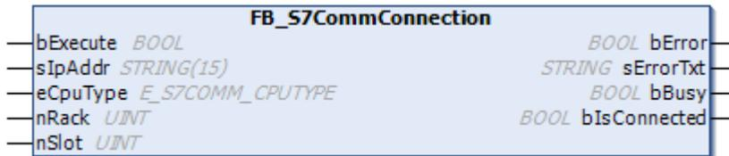
Mit dem Funktionsbaustein FB\_S7CommConnection kann eine TCP/IP basierte Verbindung zu einer Siemens S7 Steuerung hergestellt werden. Über den Ausgang bIsConnected kann festgestellt werden, ob die Verbindung erfolgreich hergestellt wurde. Fehler beim Verbindungsaufbau werden über den Ausgang bError und sErrorTxt angezeigt.
