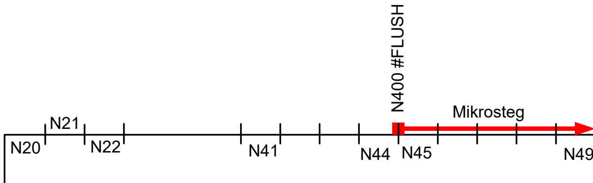
Abb. 14: Explizites Begrenzen des Wegvorlaufs der M-Funktion
