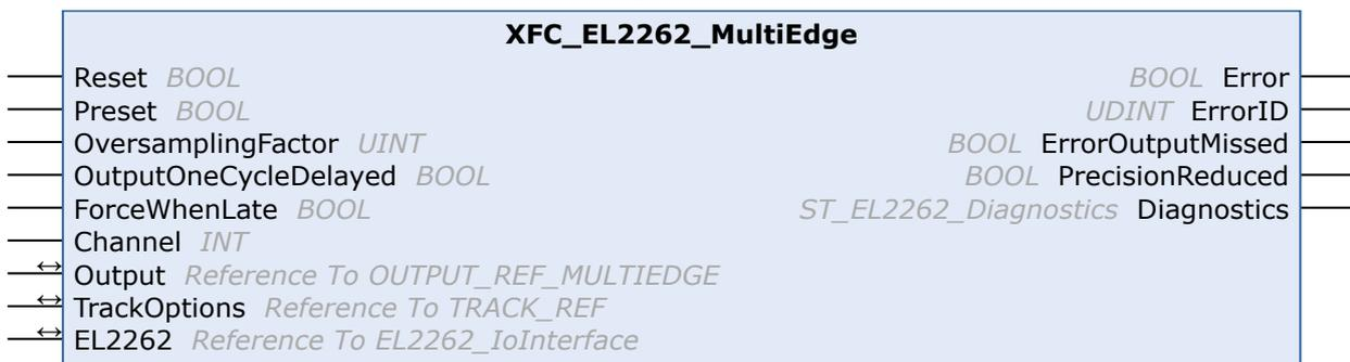
Der Funktionsbaustein XFC\_EL2262\_Multiedge wickelt die Ausgabe von digitalen Nocken mit der XFC-Oversampling-Klemme EL2262 ab.
