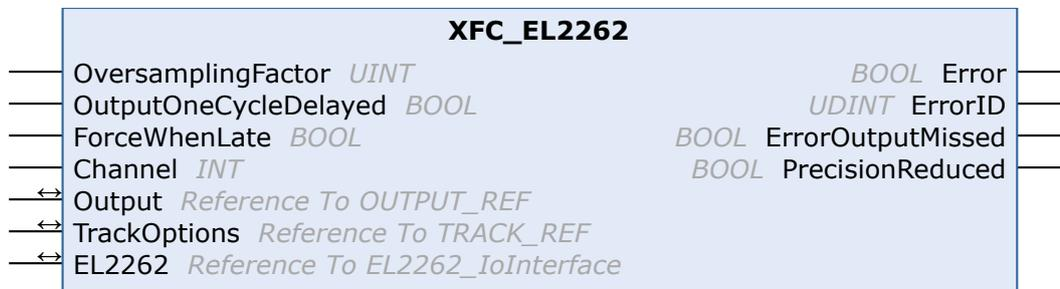
Der Funktionsbaustein XFC\_EL2262 wickelt die Ausgabe einer digitalen Nocke mit der XFC-Oversampling-Klemme EL2262 ab.
