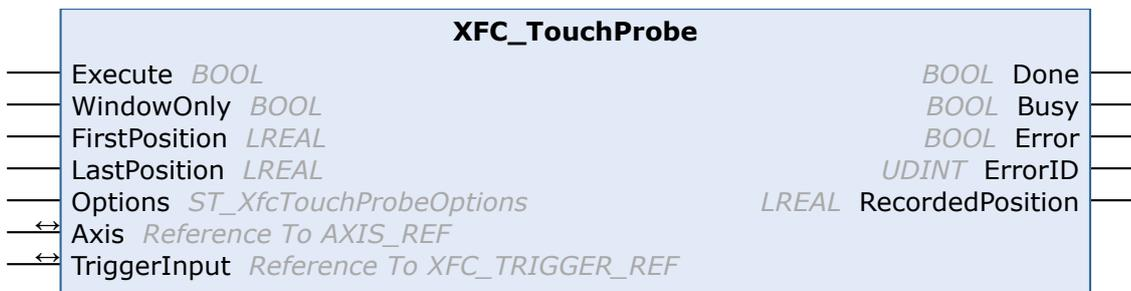
Der Funktionsbaustein XFC\_TouchProbe erfasst eine Achsposition zum Zeitpunkt der Flanke eines digitalen Eingangssignals (Messtasterfunktion).
