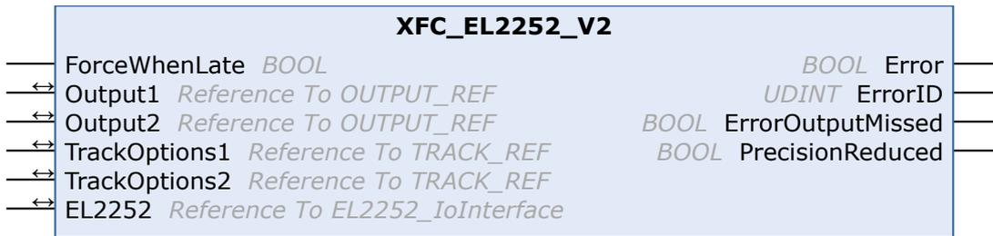
Der Funktionsbaustein XFC\_EL2252\_V2 wickelt die Ausgabe einer digitalen Nocke mit der XFC-Zeitstempelklemme EL2252 ab.
