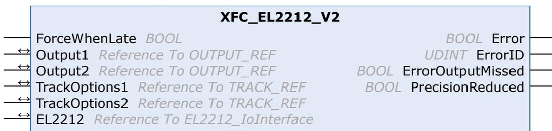
Der Funktionsbaustein XFC\_EL2212\_V2 wickelt die Ausgabe einer digitalen Nocke mit der XFC-Zeitstempelklemme EL2212 ab.
