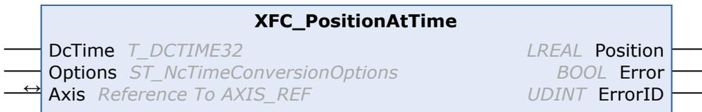
Der Funktionsbaustein XFC\_PositionAtTime berechnet eine Achsposition, welche zu einer gegebenen Zeit gültig sein wird, bzw. gültig gewesen ist.
