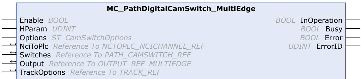
Der Funktionsbaustein MC\_PathDigitalCamSwitch\_MultiEdge ist ein digitales Nockenschaltwerk mit einer oder mehreren Nocken auf einer digitalen Ausgabespur. Der Funktionsbaustein ist in der Lage mehrere Schaltvorgänge während eines SPS-Zyklus durchzuführen. Die Schaltvorgänge werden durch Positionsnocken definiert. Weitere Ausgabespuren werden mit unabhängigen Instanzen des Funktionsbausteins realisiert.
