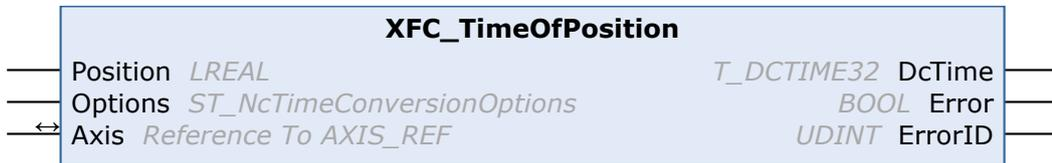
Der Funktionsbaustein XFC\_TimeOfPosition berechnet den Zeitpunkt, zu dem eine Achse an einer vorgegebenen Position sein wird, bzw. gewesen ist.
