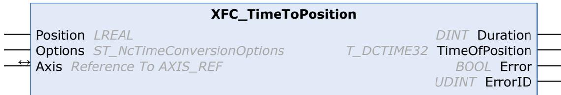
Der Funktionsbaustein XFC\_TimeToPosition berechnet die Zeitdauer, innerhalb derer eine Achse eine Position erreichen wird, bzw. die Zeitdauer, die vergangen ist, seit die Achse diese Position passiert hat.
