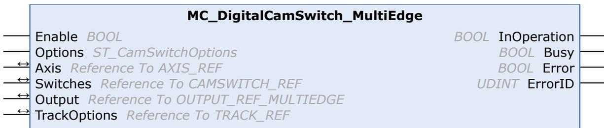
Der Funktionsbaustein MC\_DigitalCamSwitch\_MultiEdge ist ein digitales Nockenschaltwerk mit einer oder mehreren Nocken auf einer digitalen Ausgabespur. Der Funktionsbaustein ergänzt den Baustein MC\_DigitalCamSwitch um die Eigenschaft, mehrere Schaltvorgänge während eines SPS-Zyklus durchführen zu können. Die Schaltvorgänge werden durch Positionsnocken definiert. Weitere Ausgabespuren werden mit unabhängigen Instanzen des Funktionsbausteins realisiert.
