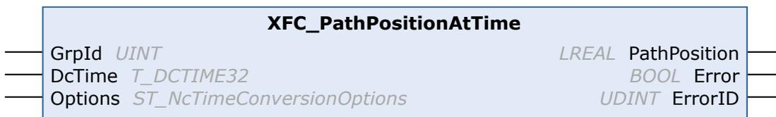
Der Funktionsbaustein XFC\_PathPositionAtTime berechnet einen relativen Bahnweg, zu einem gegebenen Zeitpunkt bezogen auf die aktuelle Bahnposition.
