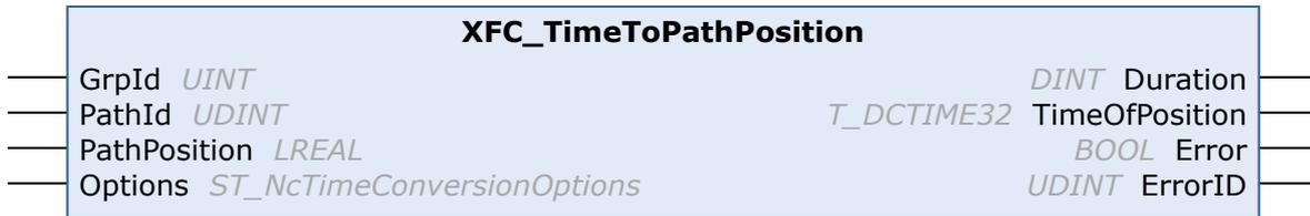
Der Funktionsbaustein XFC\_TimeToPathPosition berechnet die Zeitdauer, innerhalb der eine Nci-Gruppe einen relativen Bahnweg zurückgelegt hat bzw. die seit diesem vergangen ist.
