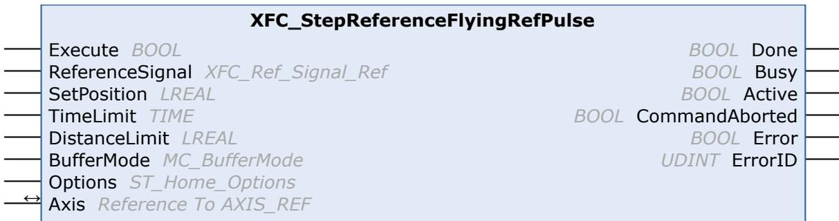
Der Funktionsbaustein XFC\_StepReferenceFlyingRefPulse führt eine Referenzierung während einer laufenden Bewegung auf den Nullimpuls eines Gebers durch.
