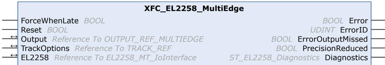
Der Funktionsbaustein XFC\_EL2258\_MultiEdge wickelt die Ausgabe eines Multi-Edge-Nockenschaltwerkes MC DigitalCamSwitch MultiEdge [► 19] über die XFC-Zeitstempelklemme EL2258 ab.
