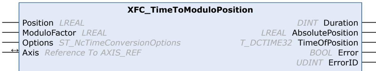
Der Funktionsbaustein XFC\_TimeToModuloPosition berechnet die Zeitdauer, innerhalb derer eine Achse eine Position erreichen wird, bzw. die Zeitdauer, die vergangen ist, seit die Achse diese Position passiert hat. Die Position ist in diesem Fall die in Fahrtrichtung nächstliegende Modulo-Position.
