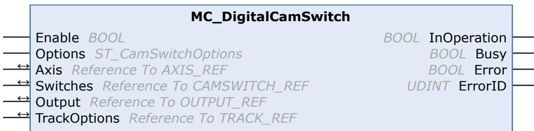
Der Funktionsbaustein MC\_DigitalCamSwitch ist ein digitales Nockenschaltwerk mit einer oder mehreren Nocken auf einer digitalen Ausgabespur.
