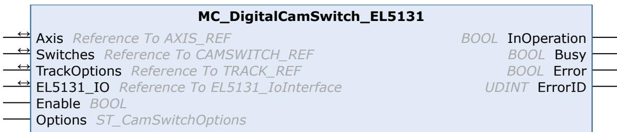
Der Funktionsbaustein MC\_DigitalCamSwitch\_EL5131 ist ein digitales Nockenschaltwerk auf Basis einer EL5131 Inkrementalencoderklemme.
