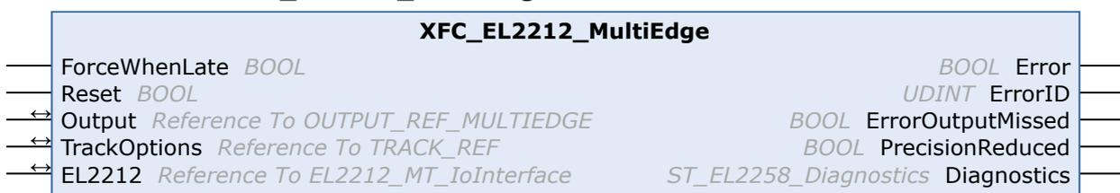
Der Funktionsbaustein XFC\_EL2212\_MultiEdge wickelt die Ausgabe eines Multi-Edge-Nockenschaltwerkes MC\_DigitalCamSwitch\_MultiEdge [▶ 19] über die XFC-Zeitstempelklemme EL2212 ab.
