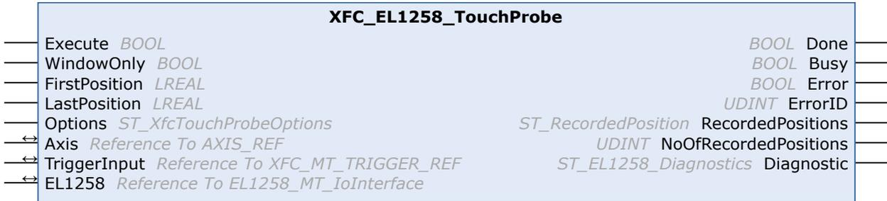
Der Funktionsbaustein XFC\_EL1258\_TouchProbe erfasst die Achspositionen zum Zeitpunkt der Flanken eines digitalen Eingangssignals (Messtasterfunktion).
