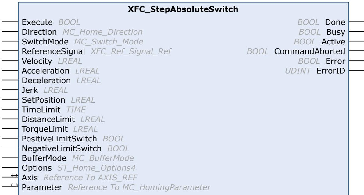
Dieser Funktionsbaustein führt eine Suche nach einem absolut positionierten externen physischen Schalter durch.
