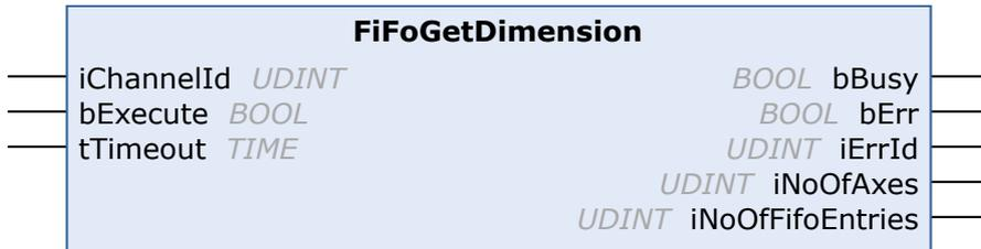
Der Funktionsbaustein ermittelt die Dimensionierung, d. h. die Anzahl der Achsen und die maximale Anzahl der FIFO-Einträge eines FIFO-Kanals.
