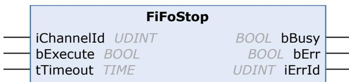
Der Funktionsbaustein FiFoStop hält einen FIFO-Kanal an, d. h., dass die Abarbeitung der Positionsdaten aus dem FIFO gestoppt wird und alle Achsen im FIFO-Kanal halten.
