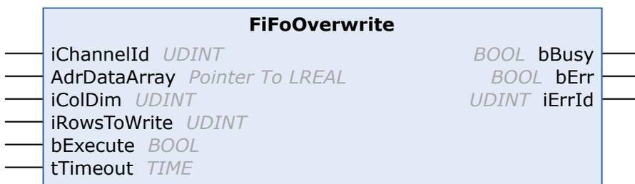
Der Funktionsbaustein FiFoOverwrite liest Positionsdaten für *iColDim*-Achsen des FIFO-Kanals aus *AdrDataArray* und überträgt *iRowsToWrite*-Einträge in den FIFO. Dabei werden bestehende Daten im FIFO überschrieben.
