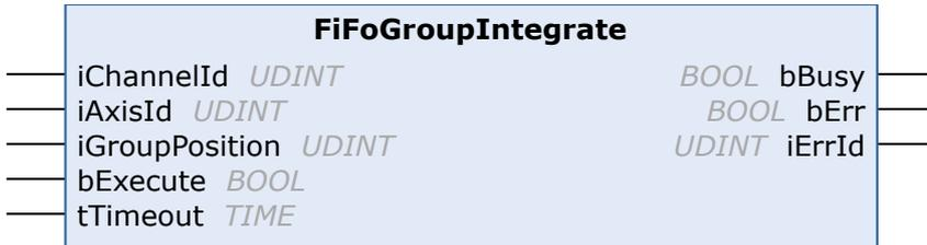
Der Funktionsbaustein FiFoGroupIntegrate integriert eine zunächst unabhängige PTP-Achse in einen FIFO-Kanal. Der Eingang *iGroupPosition* bestimmt die logische Reichenfolge und gibt an, an welcher Position innerhalb des Kanals die Achse eingefügt werden soll.
