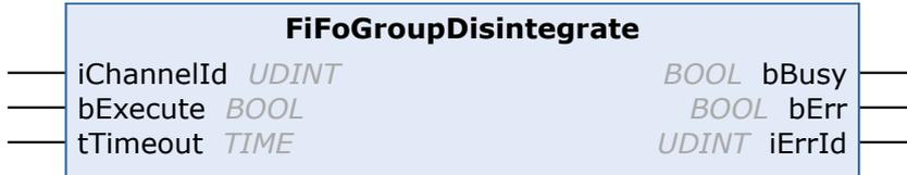
Der Funktionsbaustein FiFoGroupDisintegrate löst einen FIFO-Kanal auf, d. h. alle Achsen werden aus dem FIFO-Kanal herausgenommen und als unabhängige PTP-Achsen in den Standard-PTP-Kanal gestellt.
