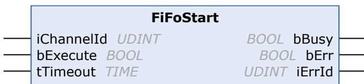
Der Funktionsbaustein FiFoStart startet die Abarbeitung des FIFO-Kanals, d. h. alle Achsen im FIFO-Kanal werden anhand der vorher im FIFO bereitgestellten Positionsdaten verfahren.
