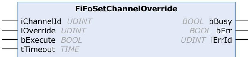
Der Funktionsbaustein FiFoSetChannelOverride setzt den Kanal-Override, über den die Abarbeitungsgeschwindigkeit des FIFO-Kanals beeinflusst werden kann. Der Kanal-Override ist nicht zu verwechseln mit dem Achs-Override der einzelnen Achsen.
