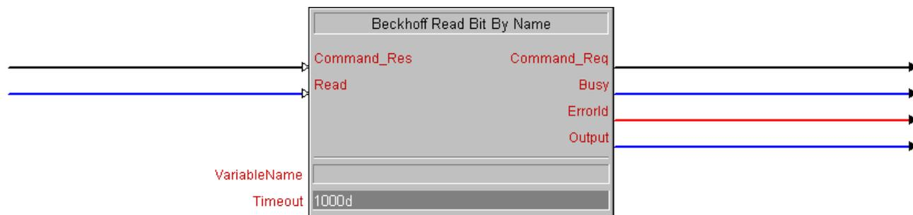
Dieser Baustein liest eine 1-Bit-Variable aus einer TwinCAT-SPS aus und stellt diese als digitales Signal an dem Ausgang *Output* zur Verfügung.
