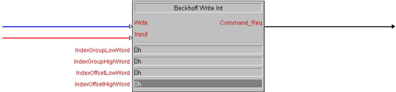
Dieser Baustein schreibt den Wert eines analogen Signals, der am Eingang *Input* anliegt, in eine 16-Bit-Variable der TwinCAT-SPS.
