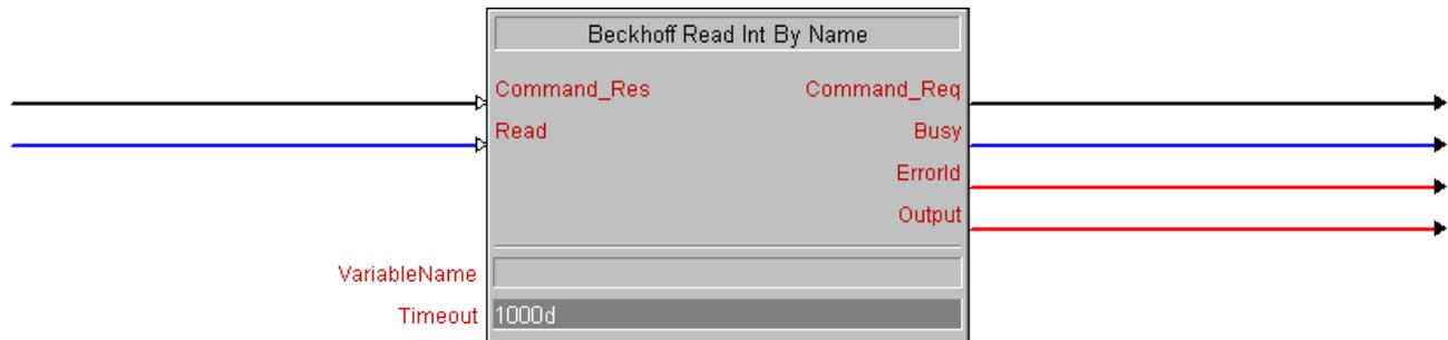
Dieser Baustein liest eine 16-Bit-Variable aus einer TwinCAT-SPS aus und stellt diese als analoges Signal an dem Ausgang *Output* zur Verfügung.
