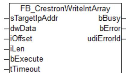
Dieser Funktionsblock erlaubt es, ein Integer Array mit einer maximalen Länge von 40 Feldern in die Crestron Steuerung zu schreiben.
