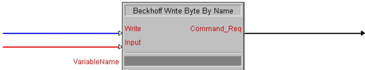
Dieser Baustein schreibt den Wert eines analogen Signals, der am Eingang *Input* anliegt, in eine 8-Bit-Variable der TwinCAT-SPS.
