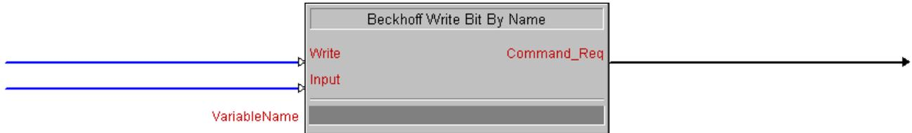
Dieser Baustein schreibt den Wert eines digitalen Signals, der am Eingang *Input* anliegt, in eine 1-Bit-Variable der TwinCAT-SPS.
