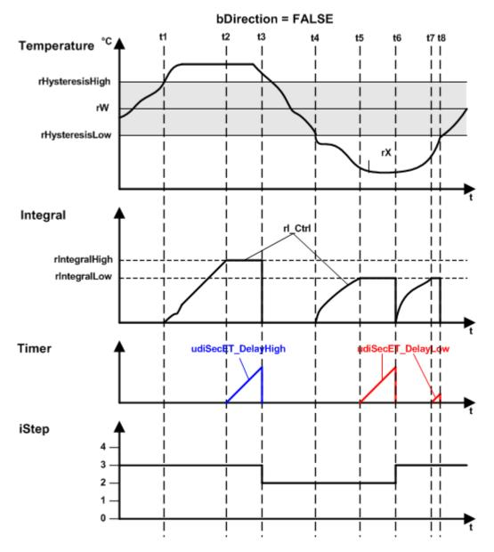
Fig. 12: FB\_HVACI\_CtrlStepDiagramm
