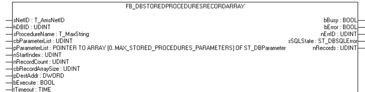
Mit dem Funktionsbaustein FB\_DBStoredProceduresRecordArray können Gespeichert Prozeduren aufgerufen werden die Datensätze zurückliefert. Im Gegensatz zum FB\_DBStoredProceduresRecordReturn können mit diesem Baustein auch mehrere Datensätze mit einem Aufruf zurückgeliefert werden. Sie können Parameter mit übergeben, die in den Gespeicherten Prozeduren verwendet werden.
