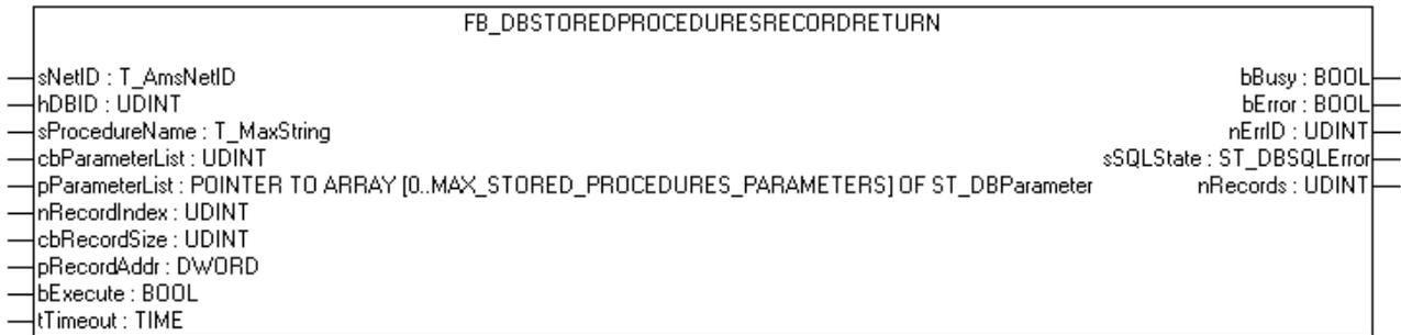
Mit dem Funktionsbaustein FB\_DBStoredProceduresRecordReturn können gespeichert Prozeduren aufgerufen werden die einen Datensatz zurückliefert. Sie können Parameter mit übergeben die in den Gespeicherten Prozeduren verwendet werden.
