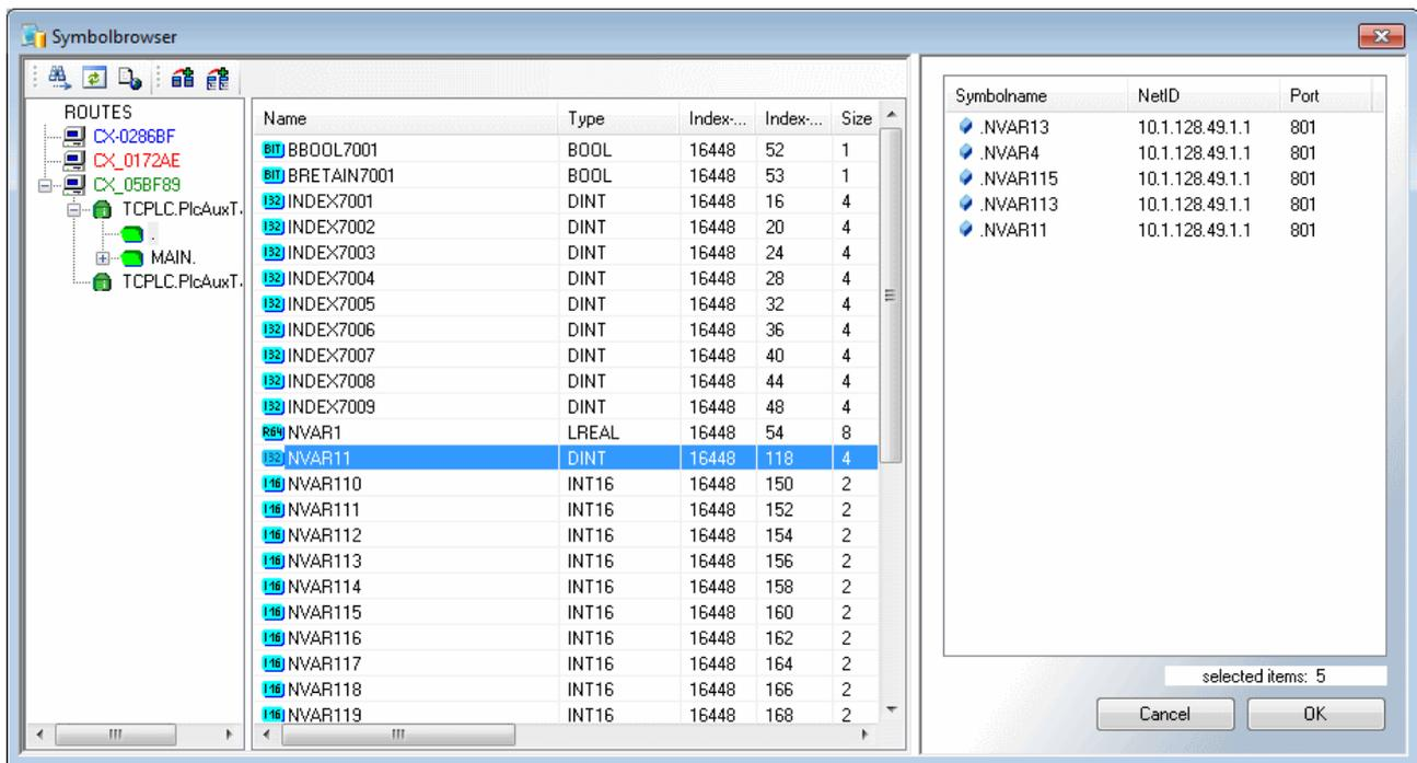
Im Target Browser können durch das Symbol mit dem Fernglas in der Toolbar auch neue ADS Ports hinzugefügt werden. Der folgende Dialog zeigt die Eingabemöglichkeit der Port-Nummer. So kann beispielsweise im System Manager im EtherCAT Device Image ein ADS Port aktiviert und hier im Konfigurator eingetragen werden. So können Werte direkt von den EtherCAT Klemmen in eine Datenbank geschrieben werden, ohne dafür die SPS zu verwenden.
