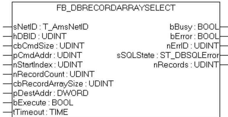
Mit dem Funktionsbaustein FB\_DBRecordArraySelect können mehrere Datensätze mit beliebiger Struktur aus einer Datenbanken ausgelesen werden. Mit diesem Baustein können sie einen SQL SELECT Befehl mit bis zu 10000 Zeichen ausführen.
