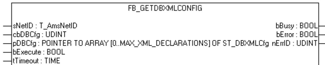
Mit dem Funktionsbaustein FB\_GetDBXMLConfig können alle Datenbanken, die in der XML - Konfigurationsdatei deklariert sind, ausgelesen werden.
