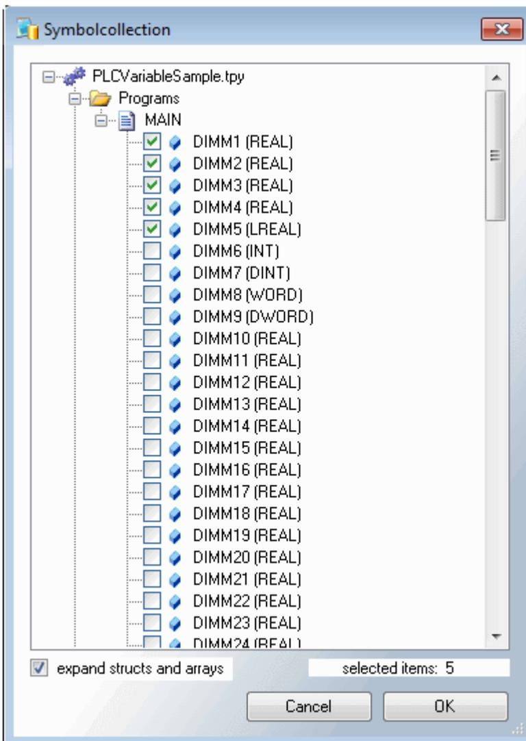
Für das Beispiel wählen Sie die ersten fünf Variablen aus der Symbolsammlung. Sie können den LogMode für jede Variable ändern, so wie es im nächsten Bild gezeigt wird. Sie müssen nun die AdSID und die DBID setzen, die Sie von den vorherigen Seiten kennen.
