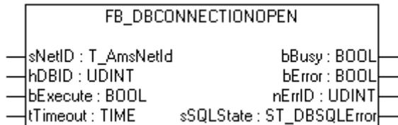
Mit dem Funktionsbaustein FB\_DBConnectionOpen können Verbindungen zu Datenbanken geöffnet werden. Dies kann den Lese- Schreibzugriff mit den Funktionsblöcken FB\_DBWrite, FB\_DBRead, FB\_DBRecordInsert und FB\_FBRecordSelect beschleunigen.
