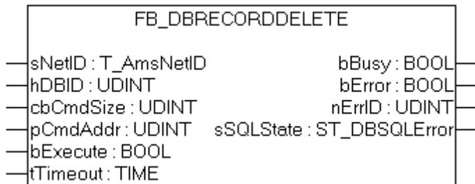
Mit dem Funktionsbaustein FB\_DBRecordDelete können einzelne Datensätze aus einer Datenbank gelöscht werden. Mit diesem Baustein können SQL DELETE Befehle mit bis zu 10000 Zeichen ausgeführt werden. Für die Benutzung des Funktionsblocks ist es erforderlich, die Datenbank, aus der Datensätze gelöscht werden sollen, in der XML - Konfigurationsdatei zu deklarieren.
