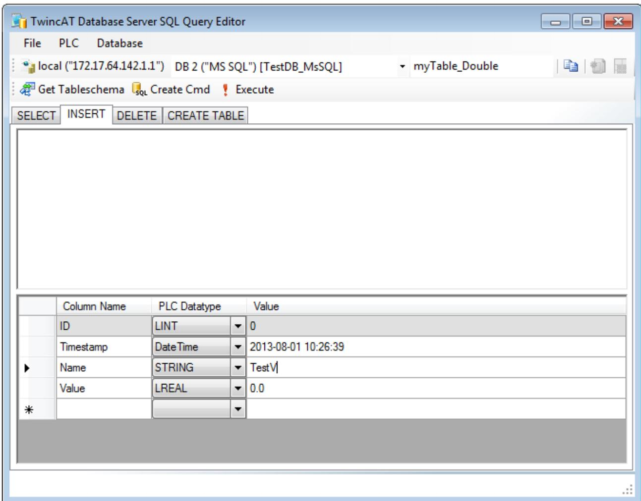
Wenn alle Spaltenwerte eingegeben wurden, und der Button "Create Cmd" gedrückt wird, wird der INSERT-SQL-Befehl in der richtigen Datenbanksyntax erzeugt. Danach muss nur noch der Befehl mit dem "Execute" Button abgesetzt werden. Intern wird für diese Funktion der SPS Baustein FB\_DBRecordINSERT\_EX verwendet.
