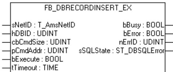
Mit dem Funktionsbaustein FB\_DBRecordInsert\_EX können einzelne Datensätze mit beliebiger Struktur in eine Datenbank geschrieben werden. Mit diesem Baustein können SQL INSERT Befehle mit bis zu 10000 Zeichen ausgeführt werden.
