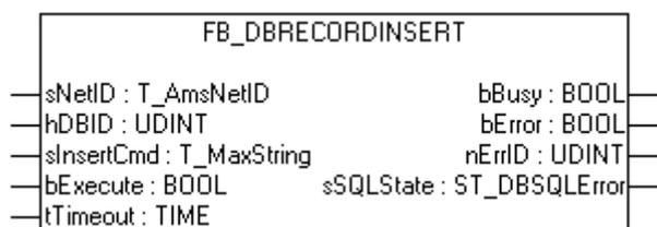
Mit dem Funktionsbaustein FB\_DBRecordInsert können einzelne Datensätze mit beliebiger Struktur in eine Datenbank geschrieben werden. Für die Benutzung des Funktionsblocks ist es erforderlich, die Datenbank, in die geschrieben werden soll, in der XML - Konfigurationsdatei zu deklarieren.
