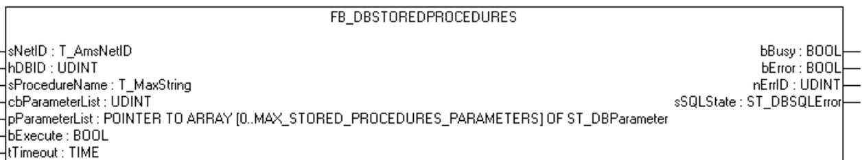
Mit dem Funktionsbaustein FB\_DBStoredProcedures können gespeichert Prozeduren aufgerufen werden. Sie können Parameter mit übergeben die in den Gespeicherten Prozeduren verwendet werden.
