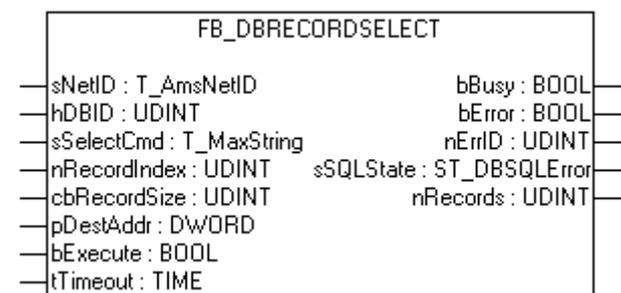
Mit dem Funktionsbaustein FB\_DBRecordSelect können einzelne Datensätze mit beliebiger Struktur aus einer Datenbank ausgelesen werden.
