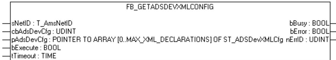
Mit dem Funktionsbaustein FB\_GetAdsDevXMLConfig können alle ADS-Geräte, die in der XML - Konfigurationsdatei deklariert sind, ausgelesen werden.
