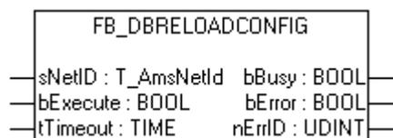
Mit dem Funktionsbaustein FB\_DBReloadConfig kann die XML-Konfigurationsdatei neu eingelesen werden. Wurden Änderungen an der XML-Konfigurationsdatei vorgenommen, muss dem Database Server die Änderungen mit Hilfe des FB\_DBReloadConfig bekannt gemacht werden.
