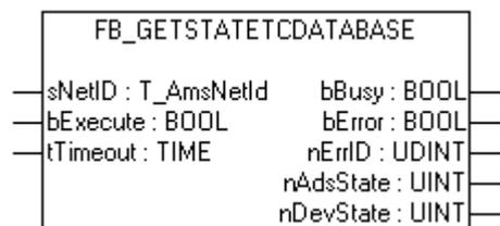
Mit dem Funktionsbaustein FB\_GetStateTcDatabase kann der aktuelle Status des Database Servers abgefragt werden.
