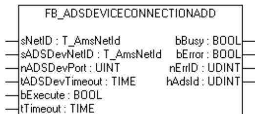
Mit dem Funktionsbaustein FB\_AdsDeviceConnectionAdd können AdsDevices in der XML - Konfigurationsdatei deklariert werden.
