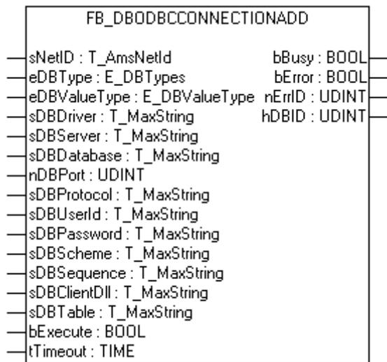
Mit dem Funktionsbaustein FB\_DBOdbcConnectionAdd können weitere ODBC-Datenbankverbindungen an die XML-Konfigurationsdatei angefügt werden.
