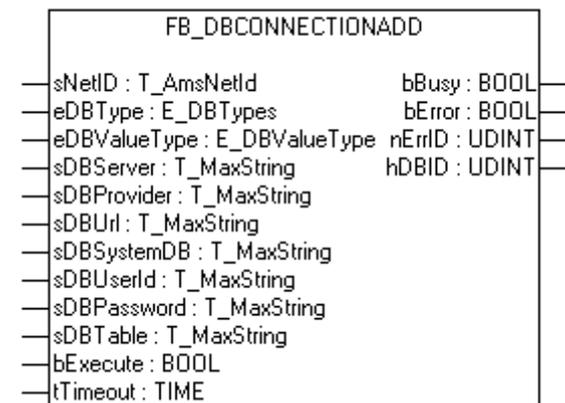
Mit dem Funktionsbaustein FB\_DBConnectionAdd können weitere Datenbankverbindungen an die XML-Konfigurationsdatei angefügt werden.
