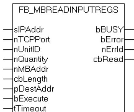
Diese Funktion wird zum Lesen von 1 bis 128 Eingangs-Register (16Bit) benutzt. Endian
