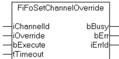
**FiFoSetChannelOverride** setzt den Kanal-Override über den die Abarbeitungsgeschwindigkeit des FIFO-Kanals beeinflusst werden kann. Der Kanal-Override ist nicht zu verwechseln mit dem Achs-Override der einzelnen Achsen.
