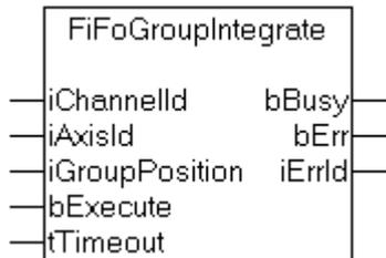
**FiFoGroupIntegrate** integriert eine zunächst unabhängige PTP-Achse in einen FIFO-Kanal. *iGroupPosition* bestimmt die logische Reichenfolge und gibt an an welcher Position innerhalb des Kanals die Achse eingefügt werden soll.
