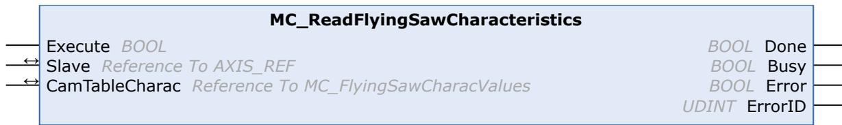
Mit dem Funktionsbaustein *MC\_ReadFlyingSawCharacteristics* können die charakteristischen Kennwerte der Synchronisierungsphase der Universellen Fliegenden Säge ausgelesen werden.
