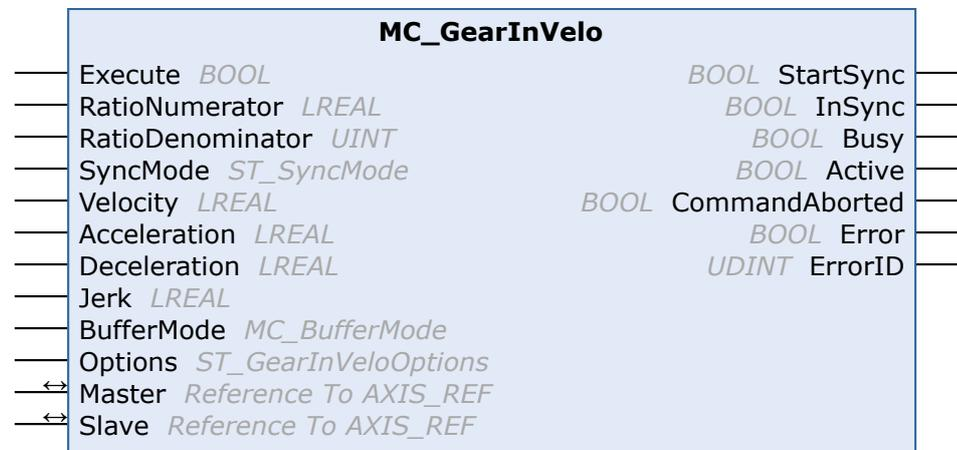
Mit dem Funktionsbaustein **MC\_GearInVelo** wird eine lineare Master-Slave-Kopplung (Getriebekopplung) aktiviert. Falls die Master-Achse bereits in Bewegung ist, synchronisiert sich die Slave-Achse auf die Master-Geschwindigkeit. Der Baustein akzeptiert einen festen Getriebefaktor im Zähler-Nenner-Format.
