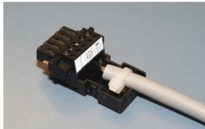
Setzen Sie die Steckerleiste in das Unterteil des Zugentlastungsgehäuses ein. Ziehen Sie den Kabelbinder fest zu und knifen Sie die Kunststoffflasche ab.
