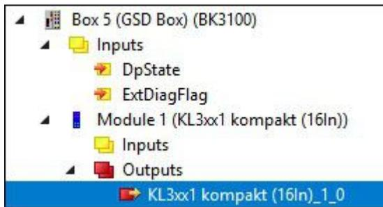
Das Bild zeigt einen simulierten BK3100 mit einer analogen Eingangsklemme. Um die Daten für den Eingang (aus Sicht des Masters) zu verknüpfen, ist ein analoger Ausgang erforderlich.
