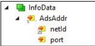
Abb. 31: CoE-Zugriff auf Multifunktions-I/Os, Eingangsvariablen "netId" und "port" unter TwinCAT.
