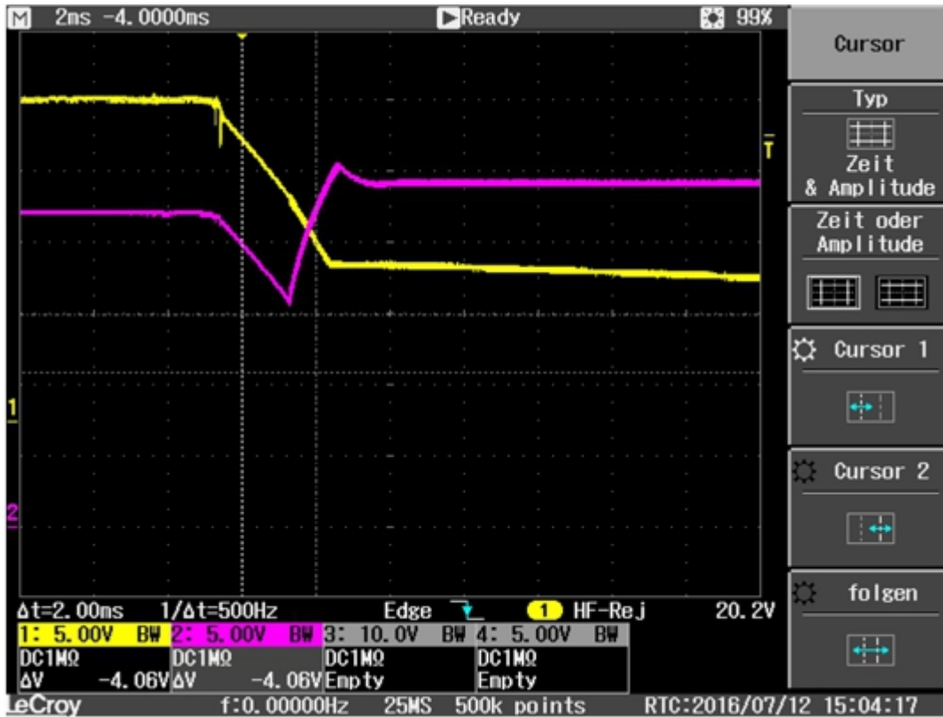
Abb. 3: Verhalten bei einem Spannungsausfall, Oszillogramm des Netzteils CX2100-0914.
