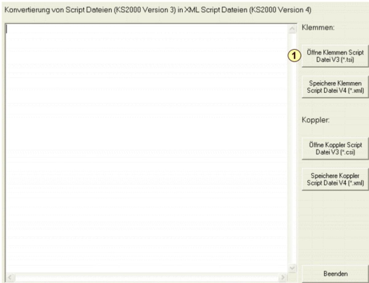
**Schritt 4:** Das folgende Fenster öffnet sich. Wählen Sie die entsprechende Datei und klicken anschließend auf *Öffnen*. (Beispieldatei: Script\_T.TSI)
