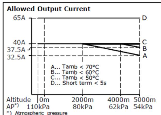
Abb. 8: Ausgangsstrom zu Umgebungstemperatur; Ausgangsstrom zu Aufstellhöhe
