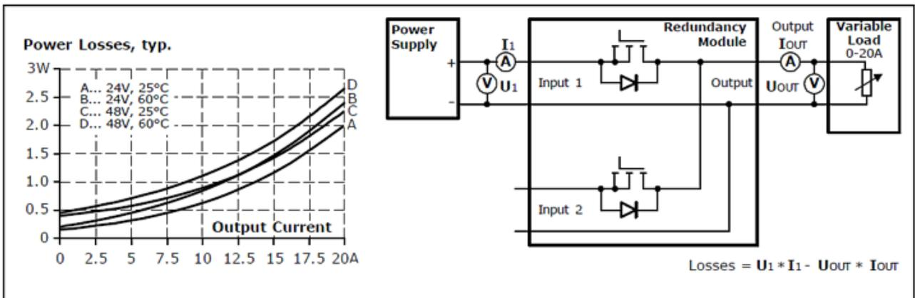
Abb. 5: Verlustleistung, wenn nur ein Eingang verwendet wird
