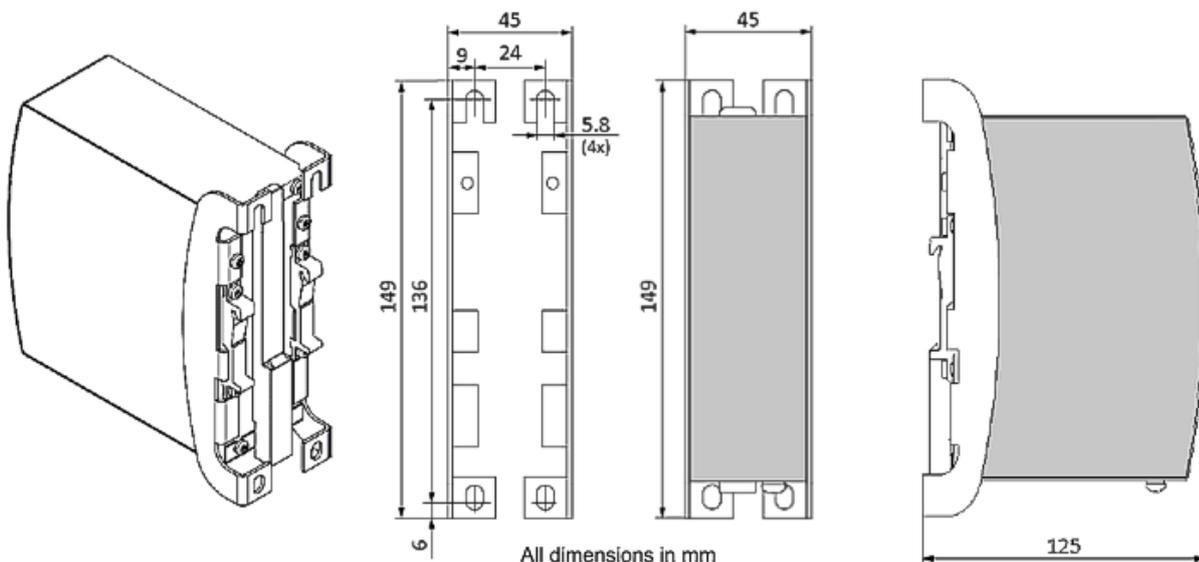
Abb. 20: Isometrische Ansicht, Einbaumaße Winkel für Wandmontage
