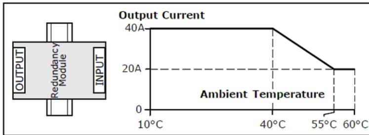
Abb. 18: Einbaulage E (Horizontal gegen den Uhrzeigersinn)
