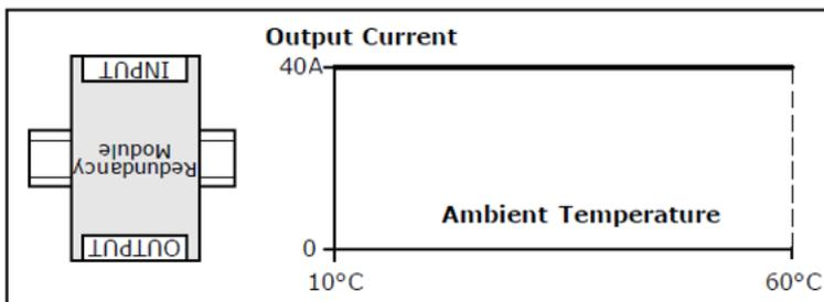
Abb. 15: Einbaulage B (auf dem Kopf stehend)
