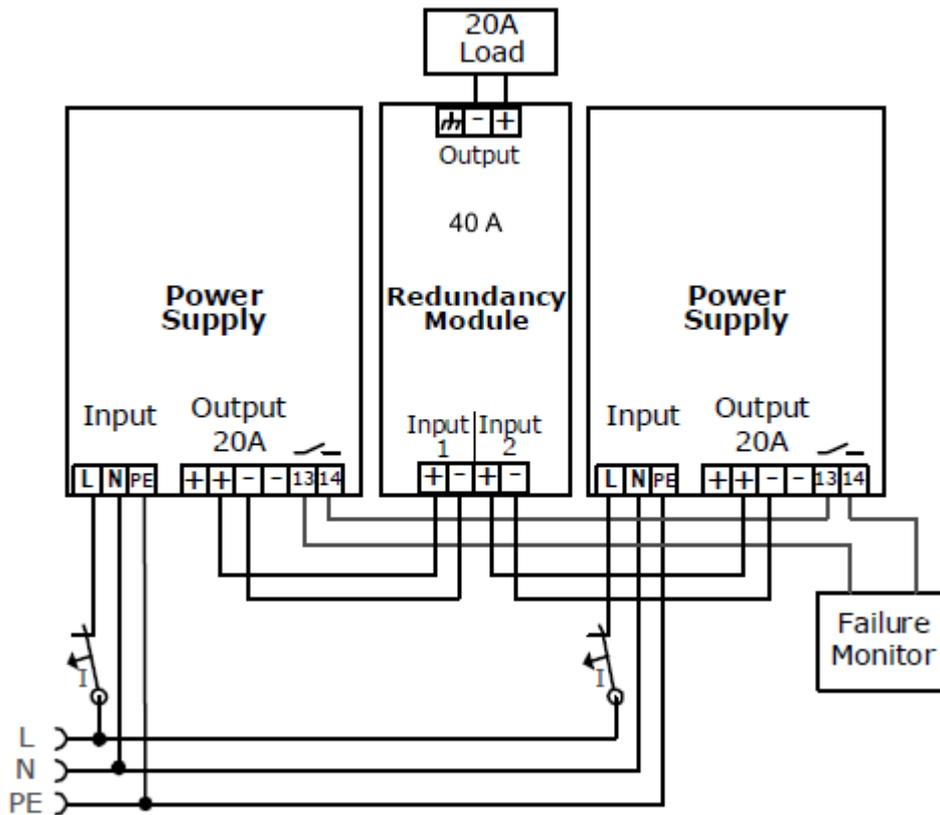
Abb. 12: Anschlussplan, 1+1 Redundanz, 20A Ausgangsstrom
