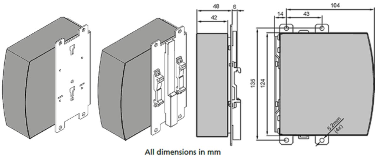
Abb. 21: Isometrische Ansicht, Seitenmontage ohne und mit DIN-Schienenhalter; Montage Abmessungen
