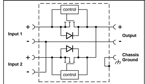
**Wiring scheme - 1+1 redundancy**
