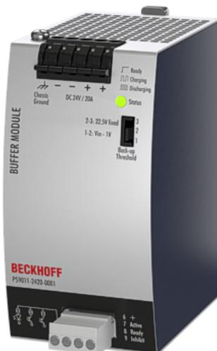
Das Puffermodul PS9011-2420-0001 ist ein Zusatzgerät für 24V-DC-Netzteile. Es liefert Strom zur Überbrückung typischer Netzausfälle oder verlängert die Überbrückungszeit nach dem Abschalten der AC-Spannung.
